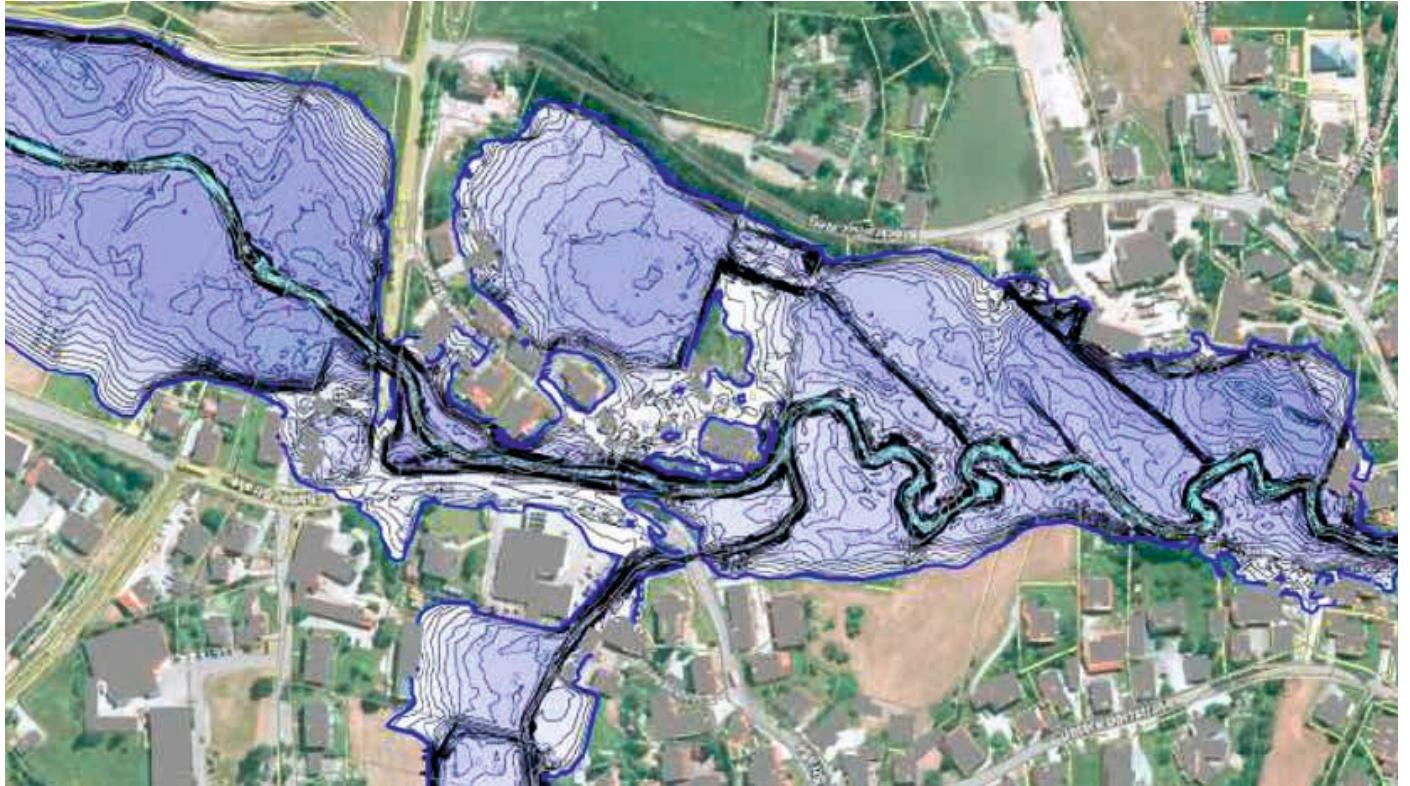
Das Bild zeigt die hydraulische Berechnung des Hochwassers.
